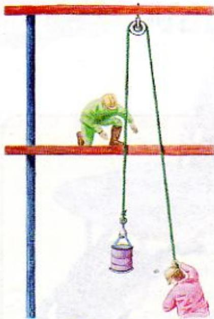
Funcionamiento de la polea fija
