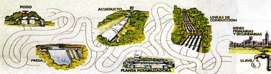
El agua que usamos se extrae del interior de la tierra a través de pozos o bien de corrientes superficiales, después se conduce por gigantescos acueductos y tuberías. Se purifica en las plantas potabilizadoras y cuando llega a la ciudad se almacena en grandes tanques para después distribuirlo por muchísimas tuberías que la llevan hasta tu casa. Cuando abres una llave, el agua se convierte en tuya; es tu agua, la que tienes que cuidar para tenerla siempre.
