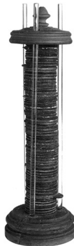
Figura 6. Pila de Volta. Discos de cobre y de zinc apilados y separados entre sí por cartones mojados con agua salada.
