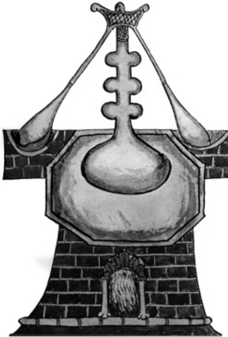
Figura 2. Equipamiento para destilar utilizado alrededor del año mil de nuestra era. El alcohol en diversas concentraciones obtenido por este método de separación no fue utilizado como bebida en las comunidades islámicas.
