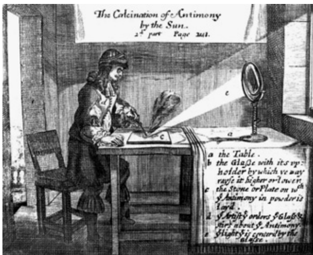
Figura 4. Calcinación del antimonio utilizando “fuego celestial”. Este diagrama proviene de un texto de N. Le Fevre de 1670, donde demuestra que las cenizas obtenidas de dicho experimento pesan más que el metal original.
