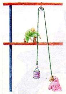
Funcionamiento de la polea fija
