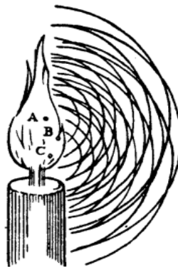
Fig. 2. Origem das Ondas por pulsos independentes conforme modelo de Huygens (Huygens, 1986, pp. 20-21)
