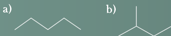
Figura 5. Representación gráfica de los isómeros estructurales con la fórmula \text{C}_5\text{H}_{12} . a) Pentano. b) 2-metilbutano.
